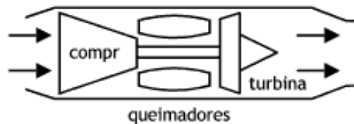
Figura 19 – Esquema construtivo de uma turbina
